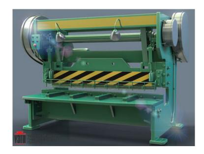
Ножницы гильотинные, или гильотины, необходимы для предварительного разрезания листовых материалов на заготовки или полосы требуемых размеров. Виды гильотинных ножниц для металла:
